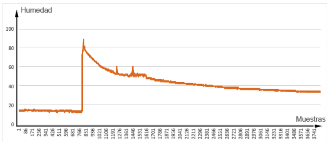
Figura 14 Humedad variable a lo largo de un riego
