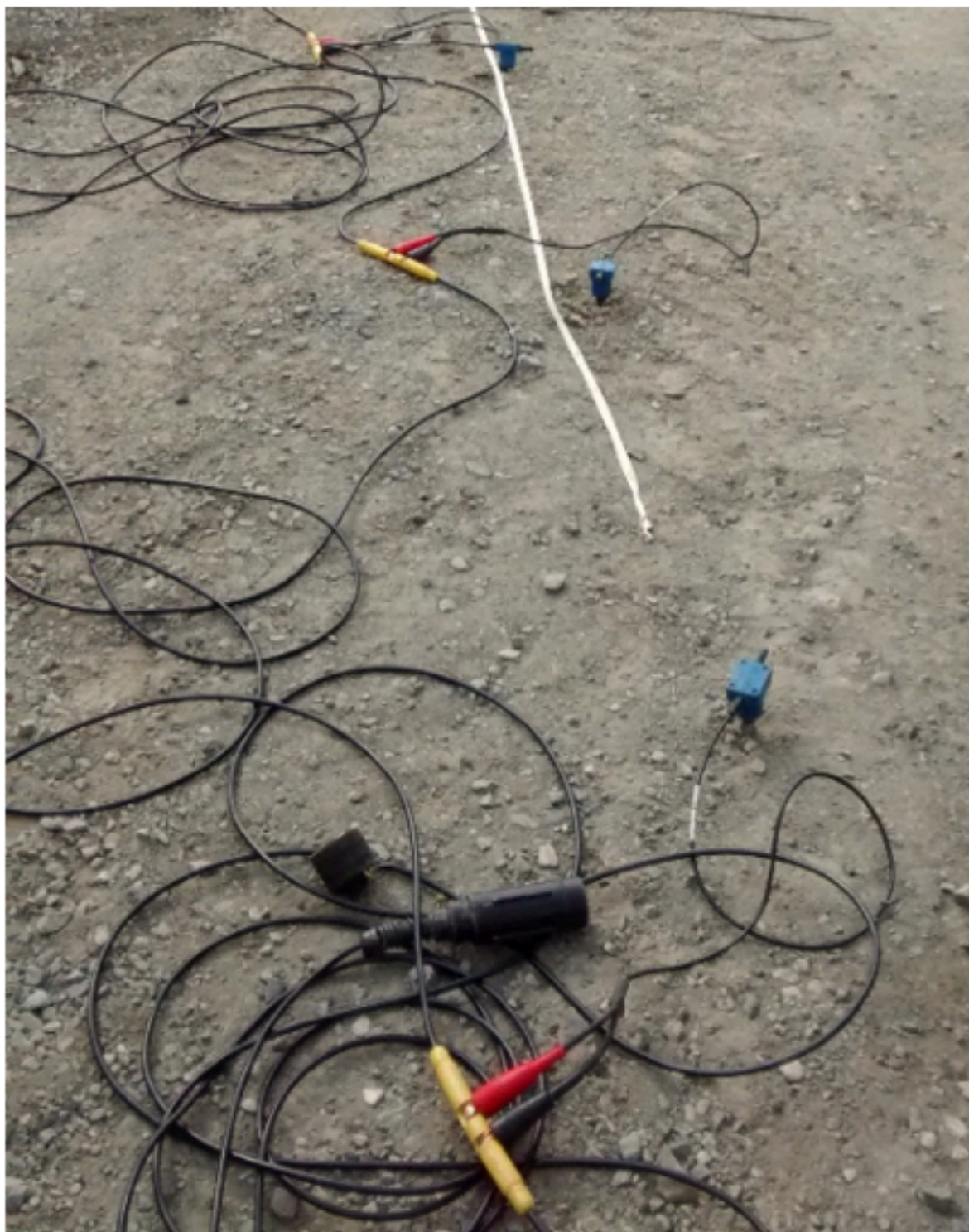
Imagen 4 . Cable de señal (cable extendido en campo y conexión al sistema de registro) Fuente: Propia (2016)
