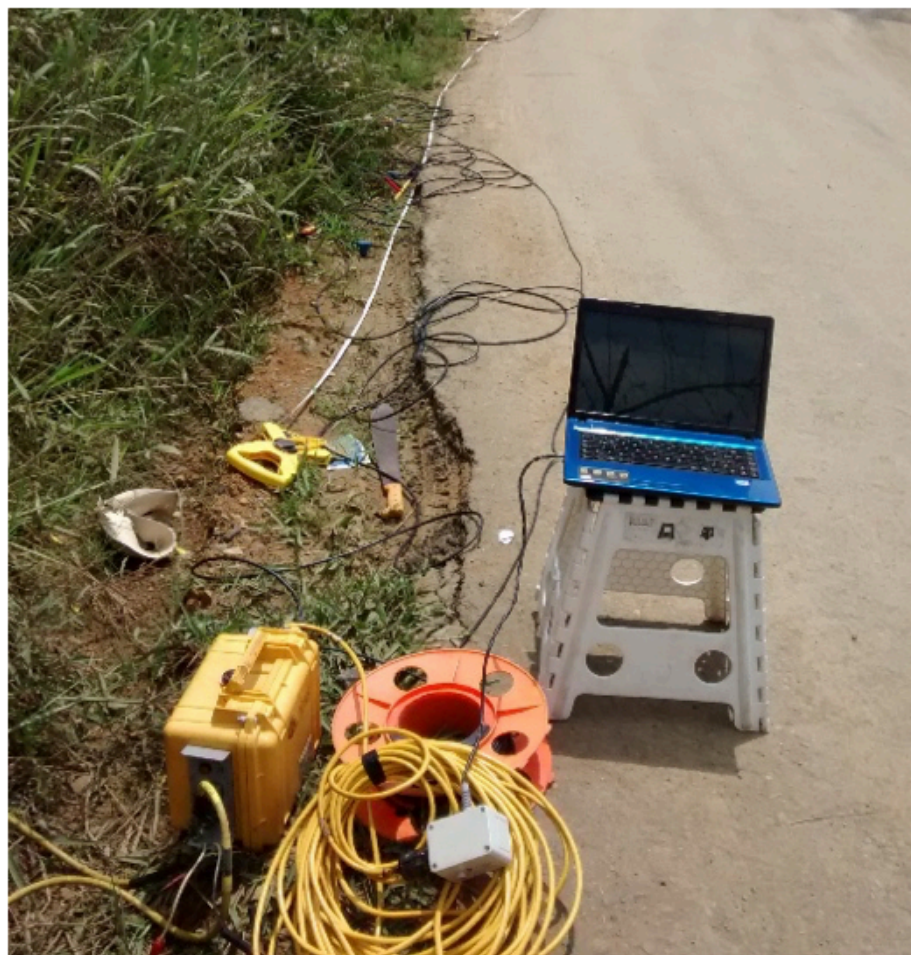
Imagen 6 . Equipo de registro de los datos (sismógrafo) Fuente: Propia (2016)
